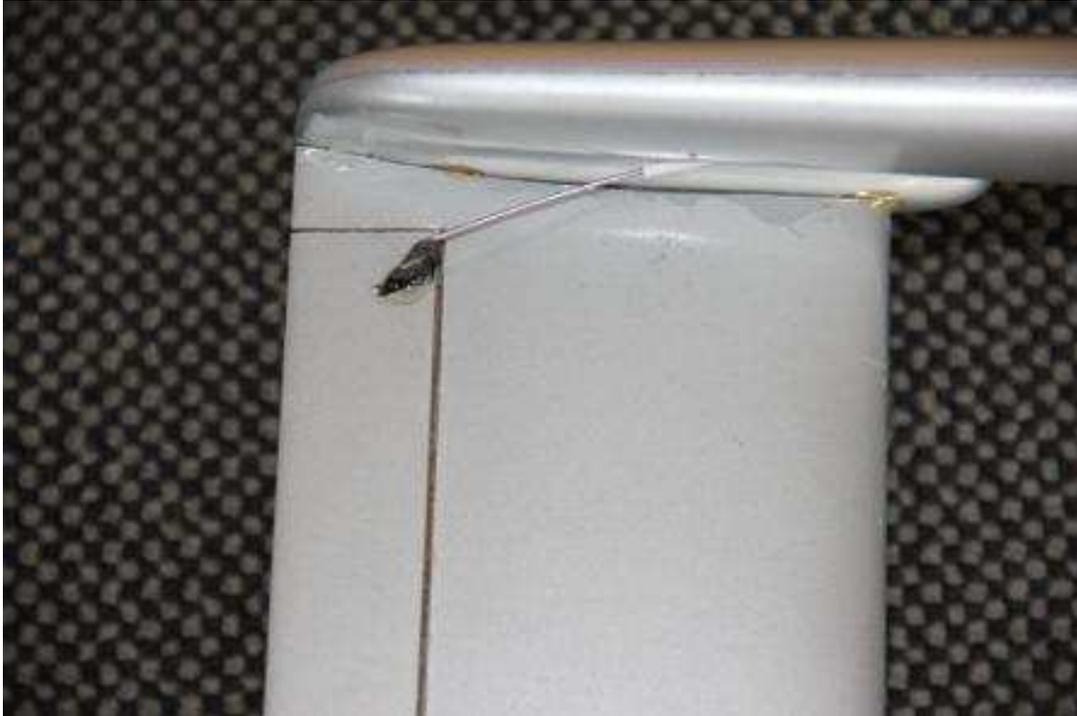
Das Höhengservokabel verlängern, der Empfänger wird seinen Platz im Cockpit finden. Danach den Servoarm neutral stellen und den Stahldraht in das untere Loch einfädeln. Nun Servo und Höhenruder nochmal neutral einstellen und das Servo gemäss Foto einkleben. Zur Sicherung des Servo mit einem Stück Balsa nach oben versperren.
